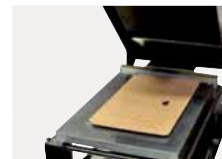
3] Опустите на контейнер крышку и произведите запивание.
